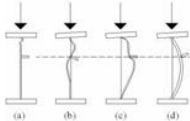
Figura 7. Diferentes modos de fallo para paneles rigidizados longitudinalmente. Graciano y Johansson [6]
